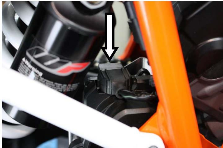
**IT** · Disconnettere il cablaggio del motore attuatore valvola
