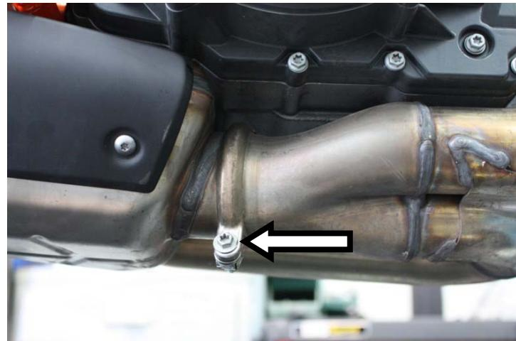
**IT** · Svitare la fascetta e sfilare il gruppo centrale catalizzato comprensivo di motore attuatore valvola
