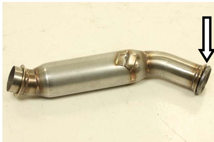
Solo per kit 71613MI/KZ: inserire nella parte anteriore del raccordo la guarnizione originale
