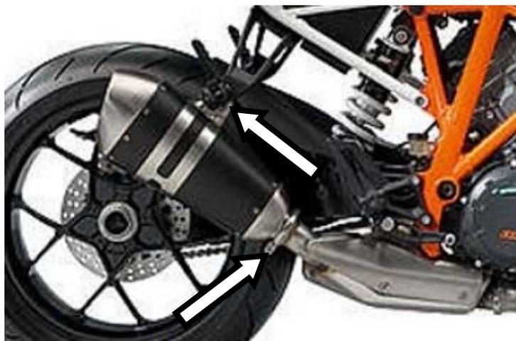
Allentare la fascetta, la vite di fissaggio e rimuovere il terminale originale
