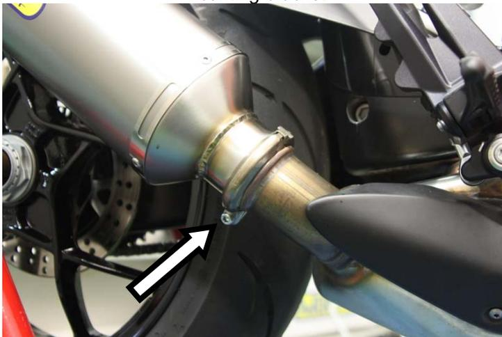
Innestare il terminale e serrarlo al raccordo mediante fascetta originale
